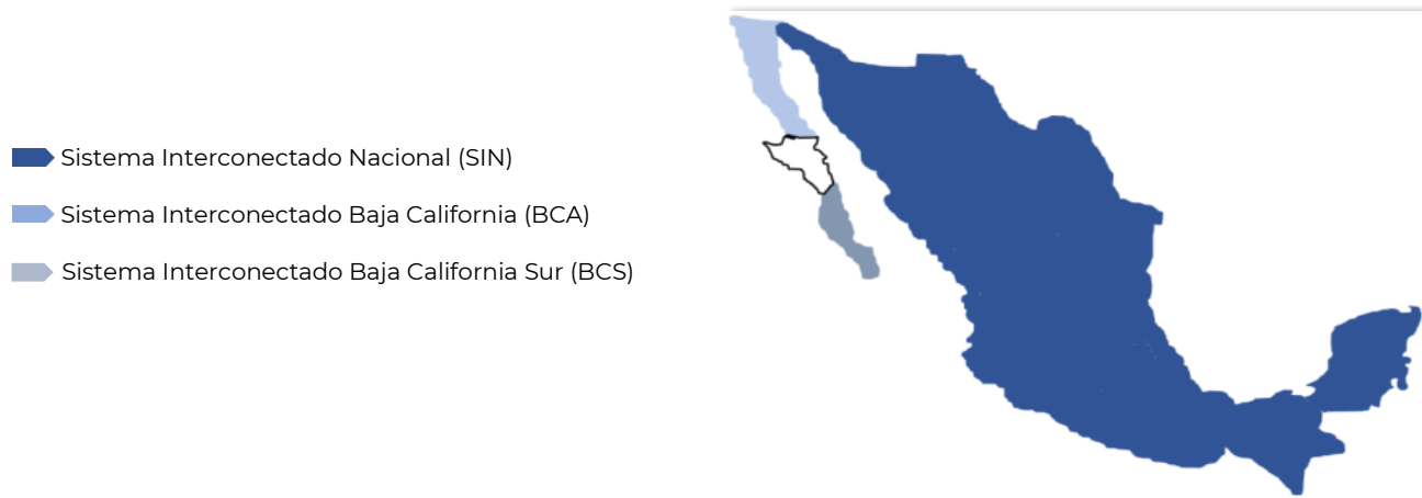
Fig. 1. Zonas de Potencia del Sistema Eléctrico Nacional
